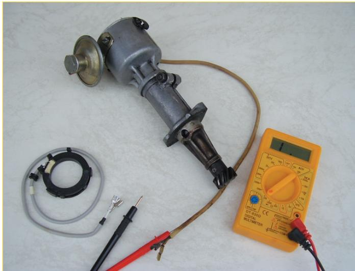
Abb. 8.2 – Defekt oder in Ordnung? Kennt man den richtigen Spulenwiderstand des Zündverteilers, gibt das Multimeter die Antwort.
