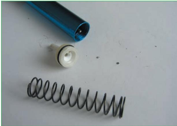
**Abb. 8.5** – Schon nach wenigen Entlötvorgängen haben sich im Zylinder einige kleine Lotklümpchen angesammelt.
