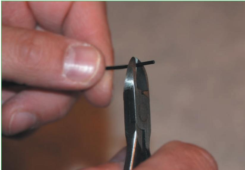
**Abb. 7.23** – Um die Stromversorgungskabel anzulöten, die Drahtenden abisolieren und ...
