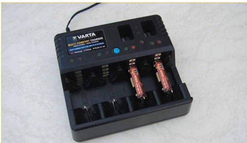
Abb. 10.17 – Praktisches vollautomatisches Ladegerät für Nickel-Cadmium- und Nickel-Metall-Hybrid-Akkus.
