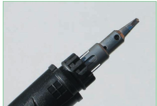
**Abb. 17.8** – Lötspitze eines GaslötKolbens.
