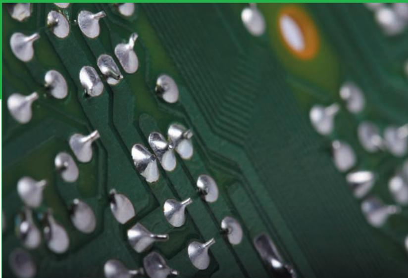
**Abb. 4.1** – Einwandfreie Lötunkte aus bleihaltigem Lötzinn sind am metallischen Glanz zu erkennen. (Foto: imago)
