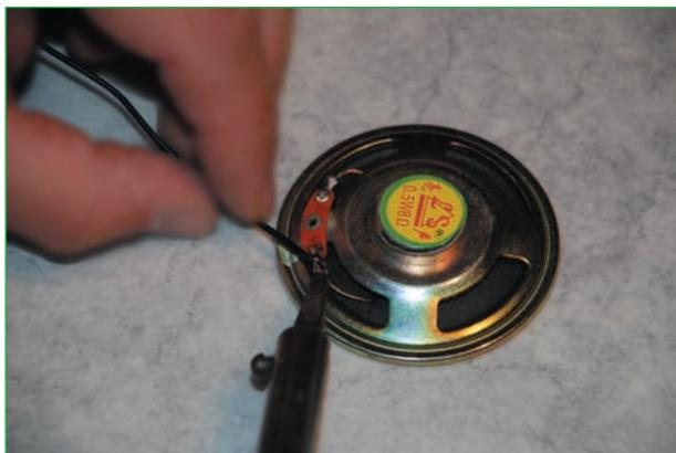
**Abb. 7.28** – Anlöten der Kabel an den Lautsprecher.
