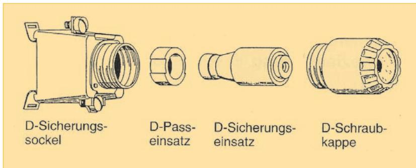
Abb. 7.12 – Die Fassung einer alten Schraubsicherung.
