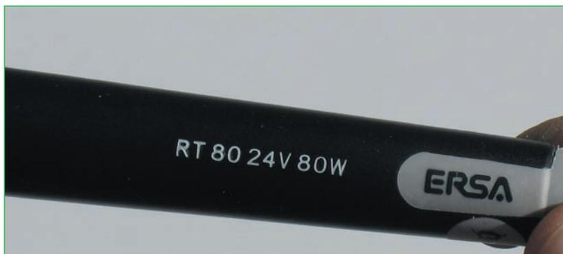
Abb. 15.6 – Der LötKolben einer Lötstation arbeitet meist mit einer niedrigen, ungefährlichen Spannung, in diesem Fall mit 24 V.
