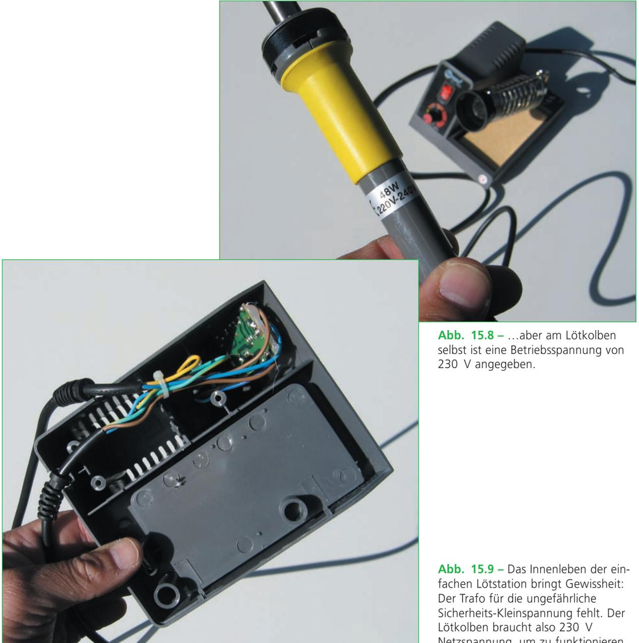
**Abb. 15.8** – ...aber am Lötkolben selbst ist eine Betriebsspannung von 230 V angegeben.
