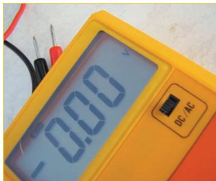
Abb. 4.8 – Bei diesem Multimeter ist zwischen Gleich- und Wechselspannung umzuschalten.
