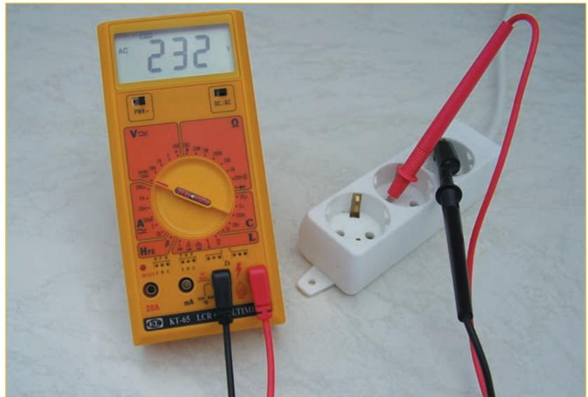
Abb. 7.13 – Spannungsmessung an einer Steckdose. Die einschlägigen Sicherheitsvorschriften sind zu beachten.
