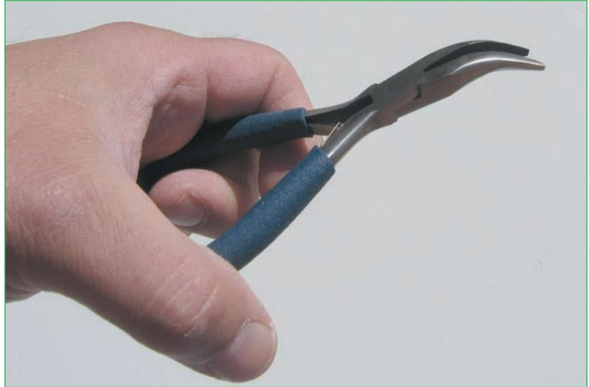
Abb. 2.5 – Gebogene Elektronikerflachzange
