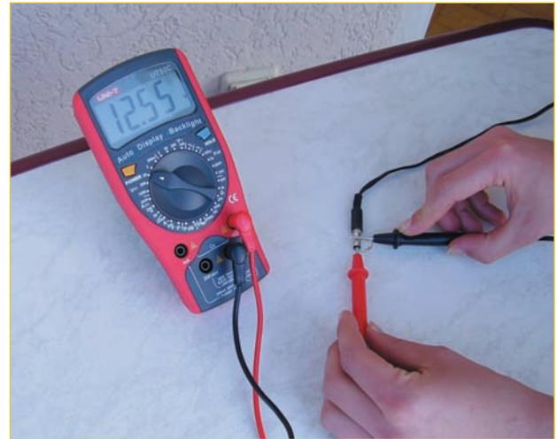
Abb. 9.10 – Auch bei Belastung mit einem 100- $\Omega$ -Widerstand ist die Spannung noch deutlich größer als die auf dem Typenschild angegebenen 9 V.
