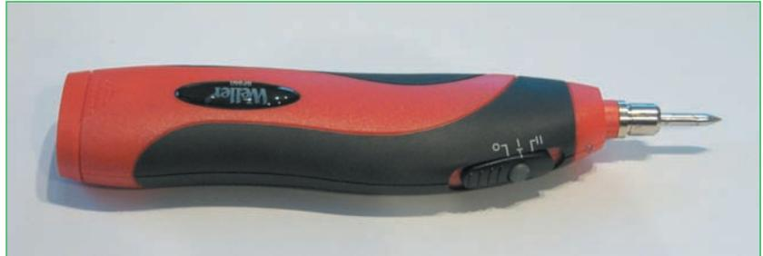
**Abb. 1.12** – Ein batteriebetriebener LötKolben mit einer Lötspitze in Bleistiftspitzenform, die sich für punktgenaue Lötungen an sehr kleinen Bauteilen und IC-Anschlüssen eignet.
