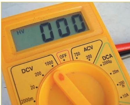
Abb. 4.7 – Blick auf ein Multimeter mit getrennten Messbereichen für die Messung einer Wechselspannung (AC V) und einer Gleichspannung (DC V).
