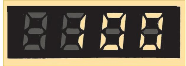
Abb. 4.1 – 1-V-Anzeige im vierstelligen 20-V-Messbereich.
