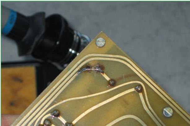
**Abb. 9.11** – Fertig eingelötete Drahtbrücke. Die defekte Leiterbahn ist repariert.
