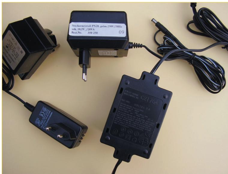
Abb. 9.7 – Verschiedene Steckernetzteile.
