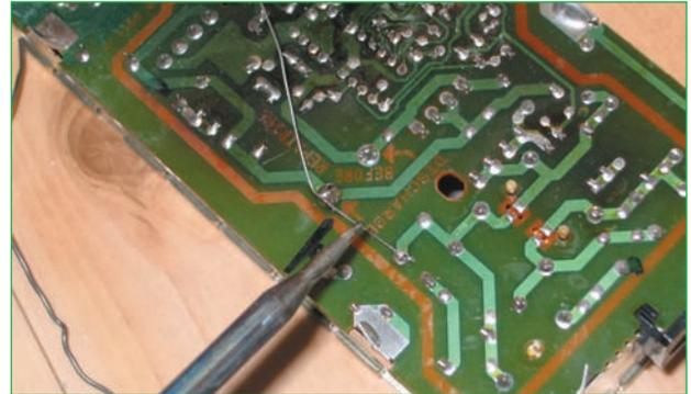
**Abb. 16.3** – Schritt 3: Den Fädeldraht mit einem scharfen Knick um den zweiten Lötunkt spannen.
