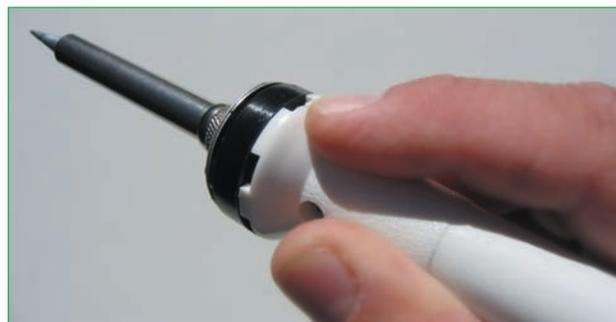
**Abb. 1.3** – Ein großzügiger Abrutschschutz beugt Verbrennungen vor.
