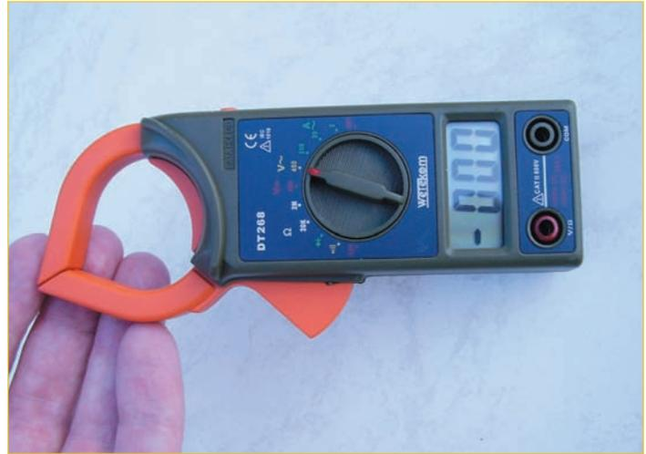
Abb. 5.3 – Ein Stromzangen-Multimeter ist kompakt und leicht.
