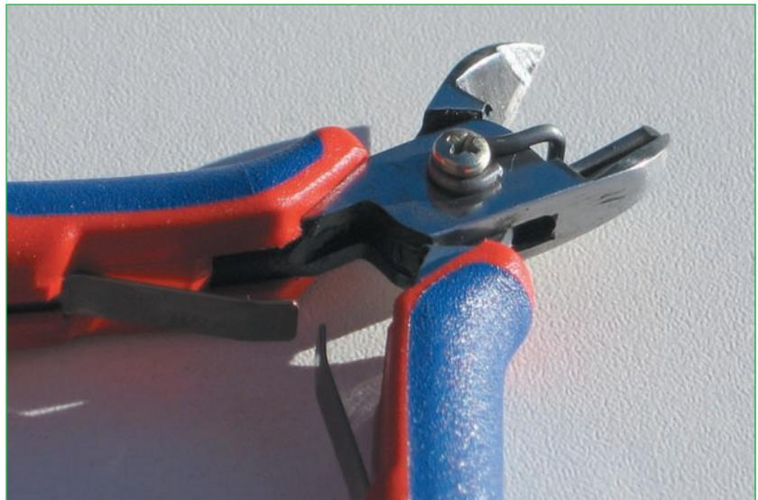
Abb. 2.6 – Elektronikerseitenschneider mit Drahtklammer
