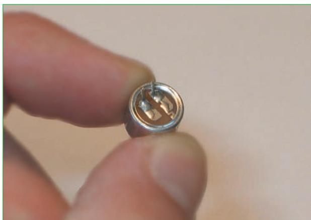
**Abb. 7.26** – Bei diesem Kondensatormikrofon ist der rechte Anschlusspunkt als Minuspol mit dem Gehäuse verbunden.
