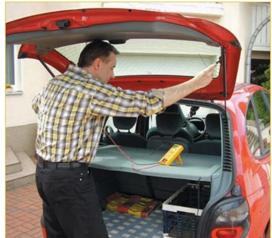
Abb. 8.3 – Durchgangstest bei der Heckscheibenheizung.
