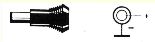
Abb. 9.11 – Typische Polarität an Stromversorgungs-Rundbuchsen.
