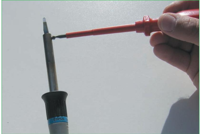
**Abb. 2.1** – Die Lötspitzen vieler LötKolben sind austauschbar. Meist ist dazu eine Schraube zu lockern.
