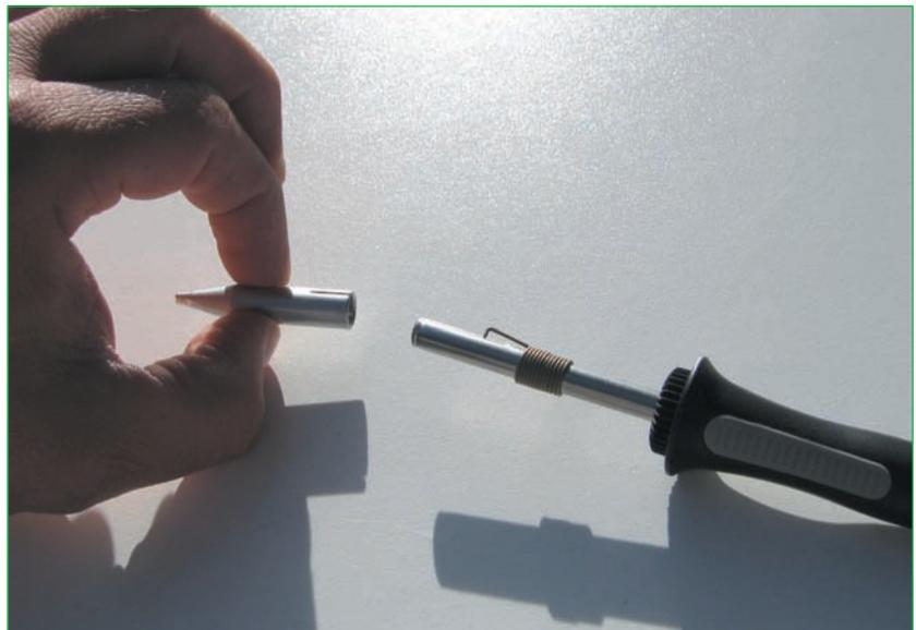
**Abb. 2.2** – Besonders komfortabel sind LötKolben mit Schnellwechsellspitze.
