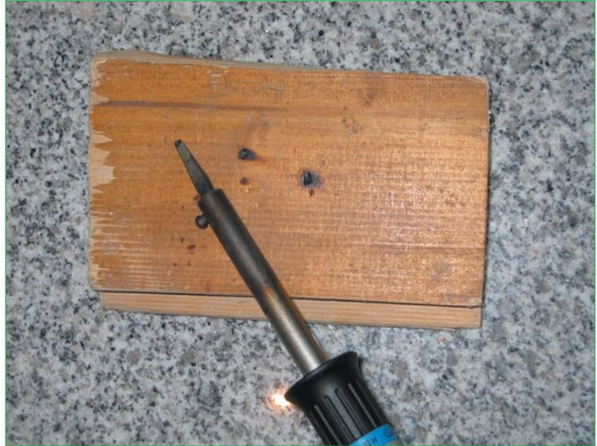
**Abb. 3.3** – Ein mittlerer 30-W-LötKolben hinterlässt bereits nach 90 Sekunden hässliche Flecken auf einem Holzstück.
