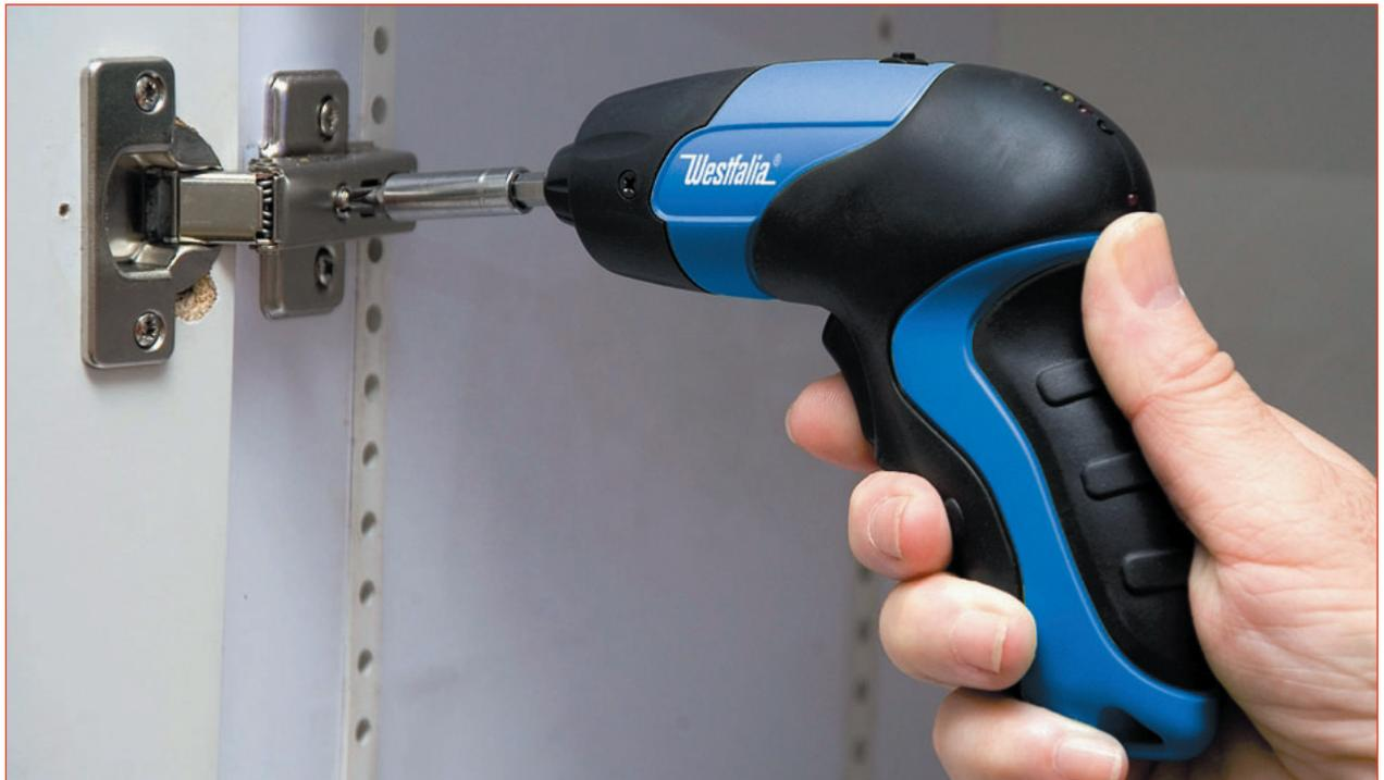
**Abb. 6.4** – Ein Akkuschrauber, der seine Stromversorgung aus einem Li-Ion-Akku bezieht, ist auch nach einer längeren Ruhepause einsatzbereit (Foto: Westfalia).
