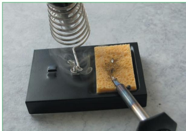
**Abb. 3.5** – Die Lötspitze regelmäßig von Verunreinigungen und überflüssigem Lot reinigen
