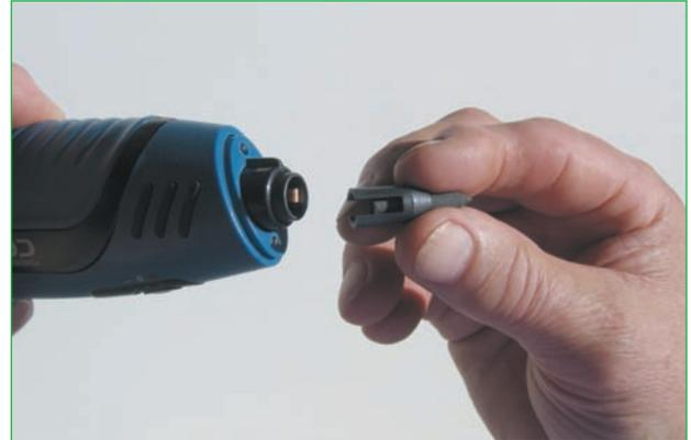
Abb. 17.2 – Die Lötspitze aus Kohlefaser ist aufgesteckt und lässt sich leicht auswechseln.
