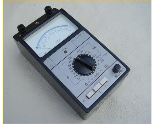
Abb. 3.1 – Ein analoges Multimeter mit Spiegelkala, die das korrekte Ablesen der elektrischen Werte sicherstellt.
