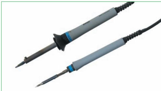
**Abb. 1.2** – Zwei typische LötKolben
