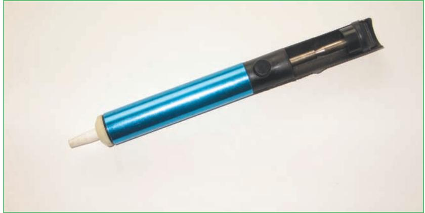
**Abb. 2.24** – Eine höherwertige Entlötpumpe ist oft an einem Metallzylinder erkennbar.
