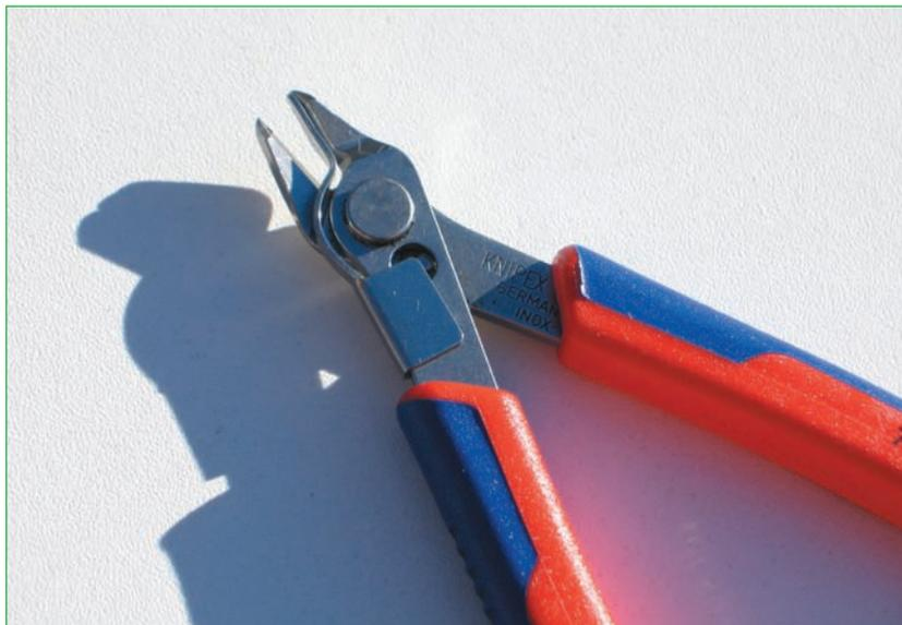
**Abb. 2.7** – Eine Printzange. Die im Bereich der Schneidefläche angebrachte Drahtklammer verhindert, dass die abgezwickten Drahtenden unkontrolliert wegspringen.
