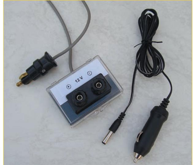
Abb. 8.1 – Selbst gebauter (links) und handelsüblicher Adapter für das Kfz-Bordnetz.
