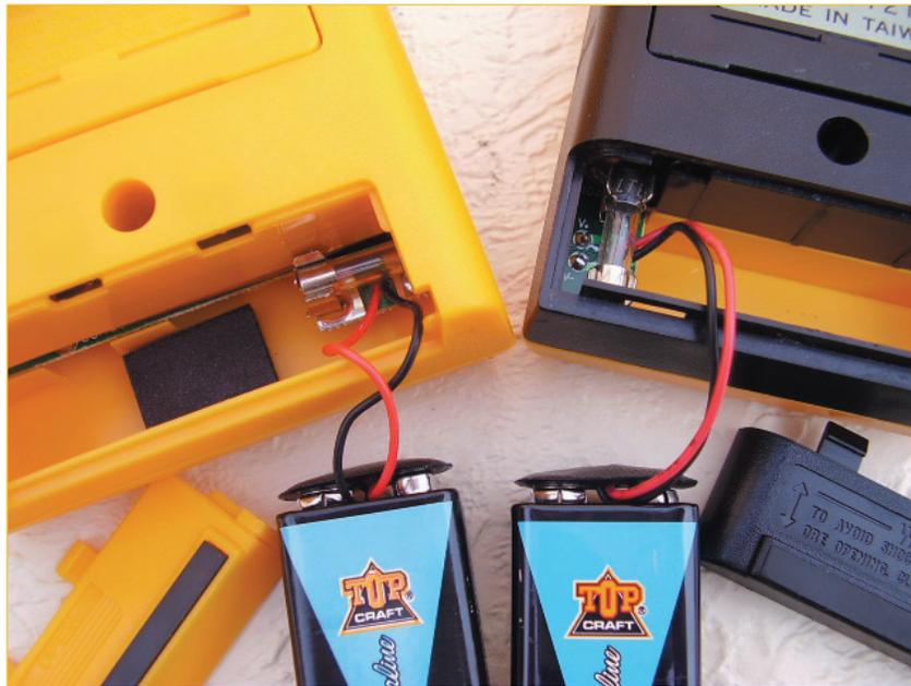
Abb. 2.2 – Sicherungen in Multimetern stecken meist im Batteriefach.
