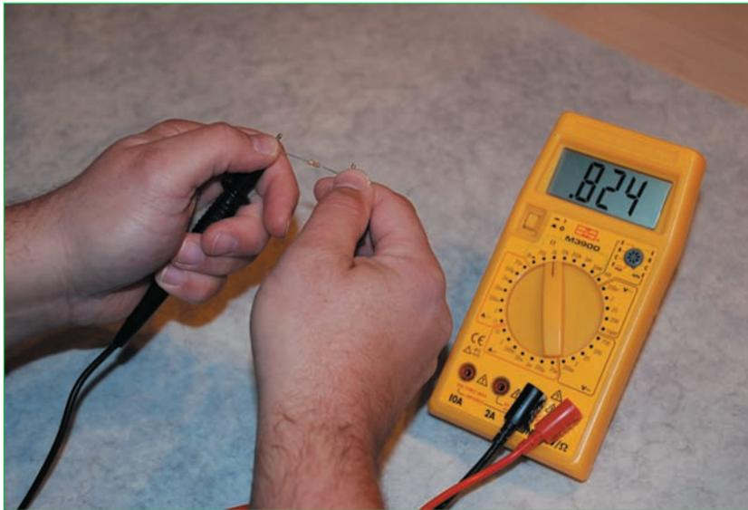
**Abb. 6.6** – Mit einem Multimeter lassen sich die Widerstandswerte schnell und genau messen.
