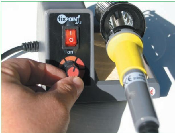
**Abb. 15.3** – Bei dieser preiswerten Lötstation ist die Arbeitstemperatur nicht exakt einstellbar, weil die Temperaturangaben fehlen.
