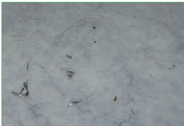
**Abb. 3.6** – Von der Lötspitze abgeschütteltes Lot verteilt sich unkontrolliert.
