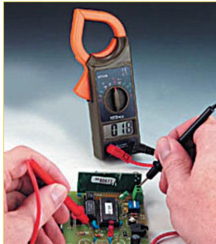
Abb. 5.5 – Mit dem Stromzangen-Multimeter kann man auch einzelne Widerstände und Spannungen in elektronischen Schaltungen messen.
