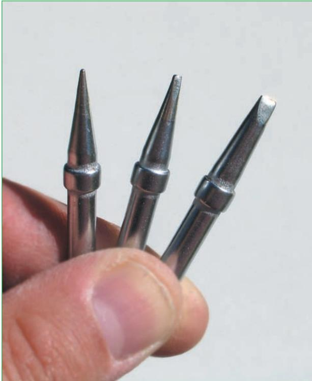
**Abb. 2.3** – Drei unterschiedliche Lötspitzen, links im Bild eine Bleistiftspitze.
