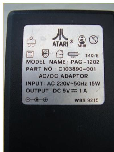
Abb. 9.8 – Das Typenschild des Steckernetzteils informiert über Ausgangsstrom und Ausgangsspannung, in diesem Fall ist es eine Gleichspannung von 9 V.
