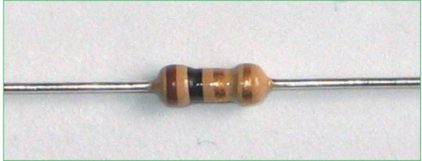
**Abb. 6.5** – Ein typischer Widerstand. Der aufgedruckte Farbcode informiert über den Widerstandswert.
