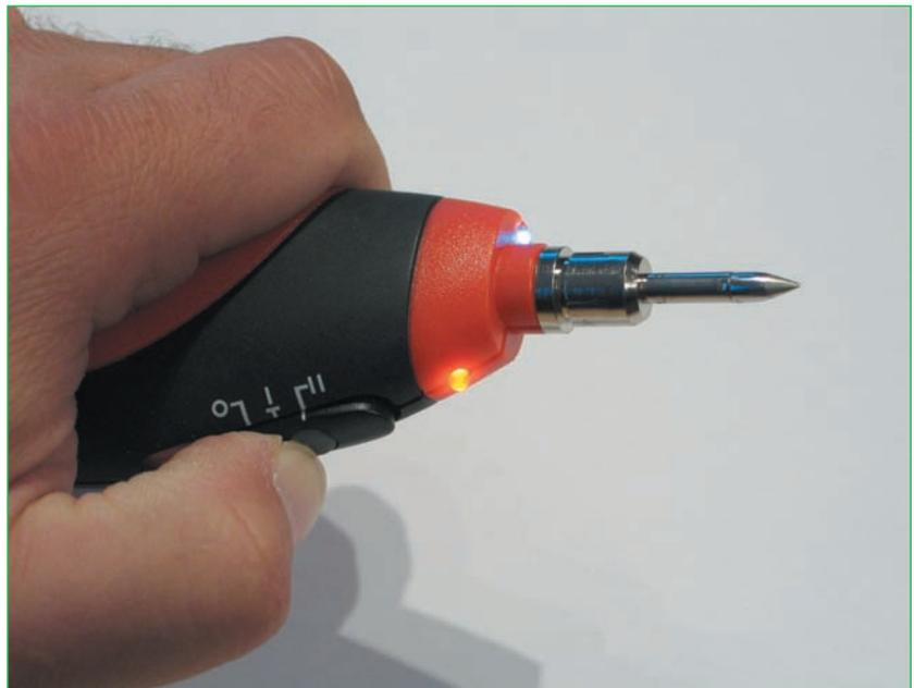
**Abb. 1.13** – Damit sich der BatterielötKolben aufheizt, ist der Taster am Schieber gedrückt zu halten. Zwei Leuchtdioden zeigen den Betriebsstatus an.
