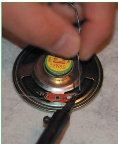
**Abb. 7.27** – Damit sich die Drähte besser anlöten lassen, sind beide Anschlusspunkte des Lautsprechers zu verzinnen.
