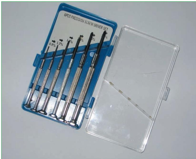
**Abb. 2.10** – Feinmechaniker-Schraubenzieher im Set
