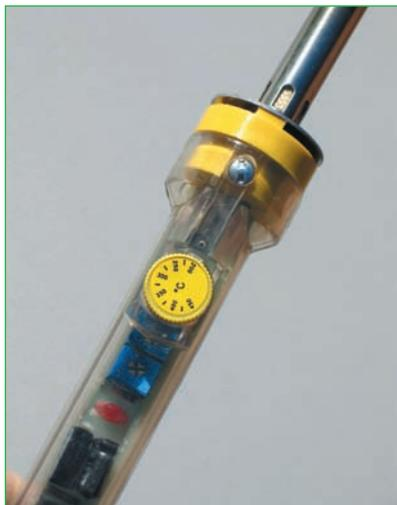
**Abb. 17.6** – Ein seltenes Exemplar: LötKolben mit einstellbarer Löttemperatur.
