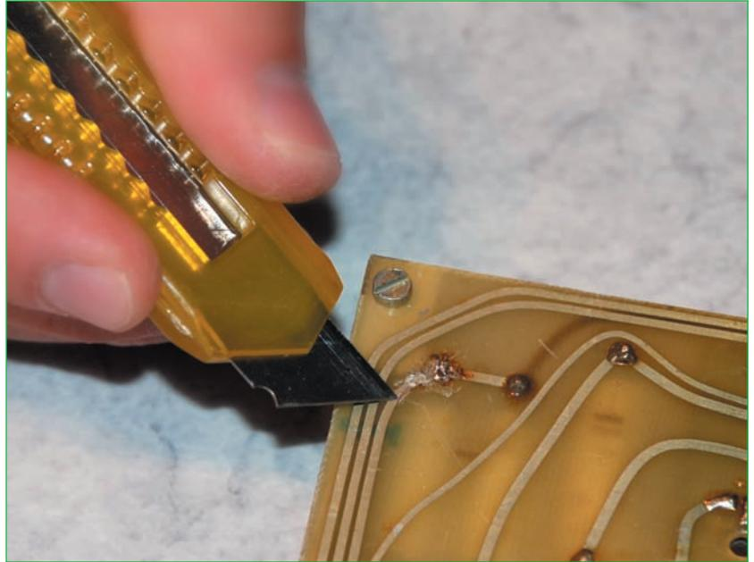
**Abb. 9.2** – Schritt 1: Nachdem Sie den losen Teil der Leiterbahn herausgeschnitten haben, schaben Sie den Isolierlack auf einem Stück der noch intakten Leiterbahn vorsichtig ab.
