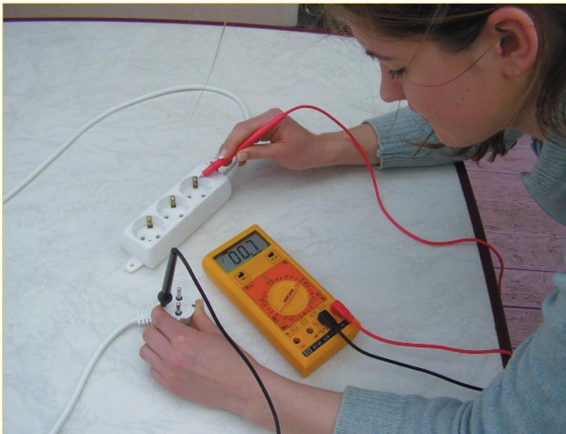
**Abb. 6.20** – Hier wird der Widerstand des Schutzleiters an einer Steckdosenleiste gemessen.
