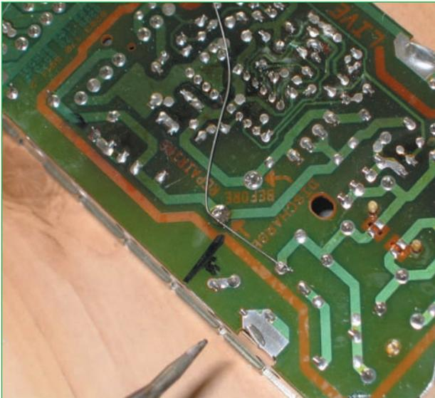
**Abb. 16.2** – Schritt 2: Das Drahtende am ersten Lötunkt anlöten.
