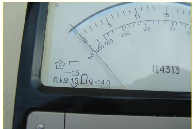
Abb. 3.2 – Hinweissymbole auf dem analogen Multimeter. Dieses Gerät besitzt eine Anzeigetoleranz von 1,5 Prozent.
