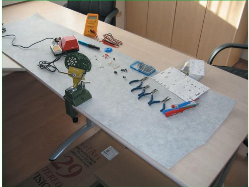
**Abb. 3.1** – Ein Reststück eines PVC-Bodenbelags eignet sich bestens als Arbeitsunterlage.
