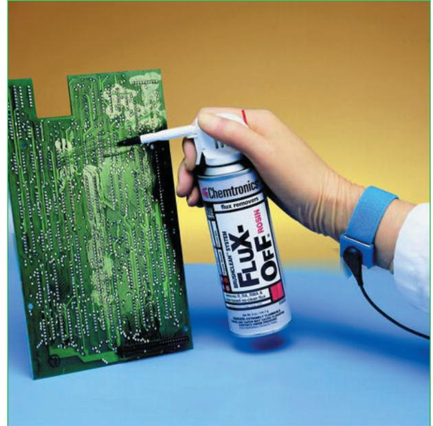
**Abb. 2.20** – Mit einem Flussmittelspray und einem Tuch lassen sich Lötückstände bequem abwischen. (Foto: Chemtronics)
