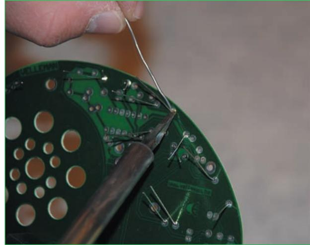
**Abb. 4.4** – Schritt 2: Die Position der Lötspitze nicht verändern, bis das Lötzinn die Lötstelle vollständig bedeckt
