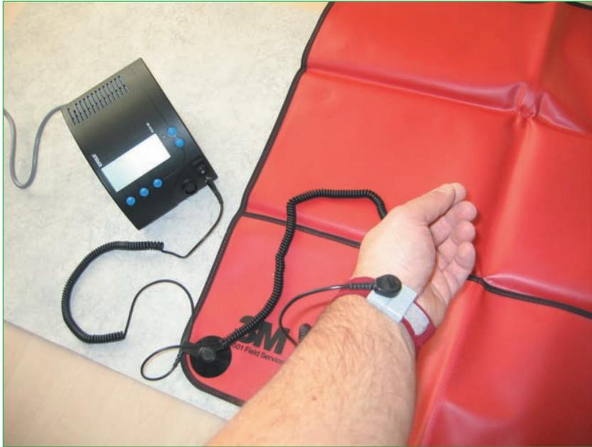
**Abb. 7.16** – Das Armgelenk ist über eine Manschette mit der Potenzialausgleichsbuchse verbunden und liegt so am für das Bauteil ungefährlichen Potenzial.
