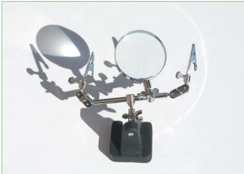
**Abb. 2.19** – Der Umgang mit diesem zierlichen Platinenhalter will gelernt sein.
