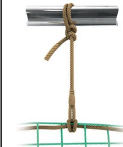
Netzaufhängung durch Umschlingen und Verknoten des Aufhängeseiles am Tragelement.
