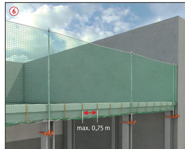
Randsicherung im unteren Bereich an Bauteilen befestigt.
