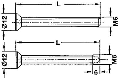
Stahl verzinkt, vernickelt oder brüniert
