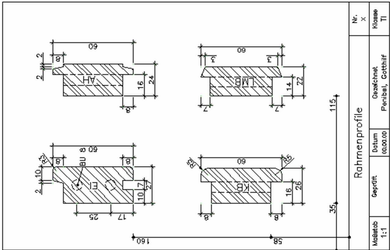
Öffnen Sie eine Vorlage DIN A 4 – Hochformat und zeichnen Sie die abgebildeten **Querschnitte** im M. 1:1 mit Bemaßung und Schraffur.
