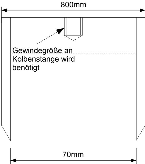
Rundstahl V4A d= 70mm
