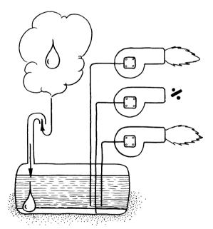
NB. Wenn in einer Heizungsanlage ein Vorhandensein von Wasser festgestellt worden ist, muss die gesamte Anlage einschliesslich aller an die Anlage angeschlossenen Ölfeuerungen gründlich gereinigt werden. Ölführende Leitungen und separat montierte Filter sind mit Luft durchzublasen.
