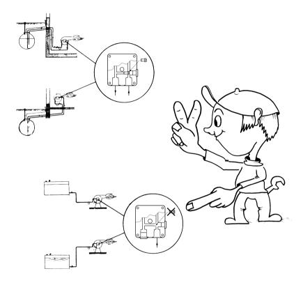
Wünscht man eine für 2-Rohrbetrieb vorgesehene Pumpe für l-Rohrbetrieb zu ändern, so ist die Schraube aus der Umlauf (G) zu entfernen und der Rücklaufstutzen mit einem Stopfen zu verschliessen. Die Anordnung der Umstellungsschraube in den einzelnen Danfoss Ölpumpen ist der Bedienungsanweisung der jeweiligen Pumpe zu entnehmen. Die MS-Pumpe hat automatische Umstellung von 1- auf 2-Strangbetrieb.
