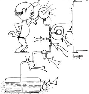
Wenn der Widerstand in der Saugleitung grösser wird, steigt das Vakuum, und wenn dieses einen Wert von ca. -0,4 bis -0,5 bar erreicht, wird sich Luft aus dem Öl abscheiden. Dabei wird in der Pumpe ein Heulton erzeugt. Wenn das Vakuum weiter steigt, setzt auch irgendwann einmal die Ölzufuhr aus. In der Regel wird man am Manometer, vielleicht auch am Vakuummeter beobachten können, wenn grössere Luftausscheidungen erfolgen, weil dann die Instrumentenzeiger sehr »unruhig« sind.
