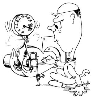
Wenn die Pumpe von einem Standardmotor angetrieben wird, so wird dieser sicherlich bei einer Druckerhöhung in der Nähe der erwähnten 50 bar »nicht mehr mitmachen«, weil mit dem Druckanstieg das Drehmoment so stark erhöht wird, dass dieses die 2- bis 3-fache normale Grösse erreicht.
