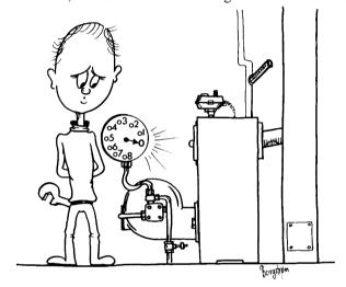
Eine Voraussetzung für den Wert der Vakauummeterprobe ist natürlich, dass das benutzte Instrument intakt und an der richtigen Stelle der Pumpe montiert ist.
